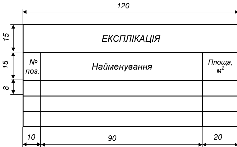
Рисунок Г.1 – Форма експлікації для креслення генерального плану та планувань виробничого корпусу
