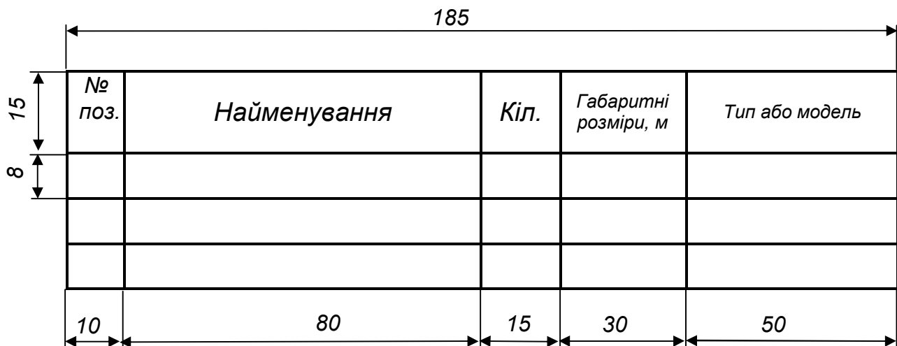
Рисунок Г.2 – Форма специфікації обладнання для технологічних планувань виробничих зон і дільниць
