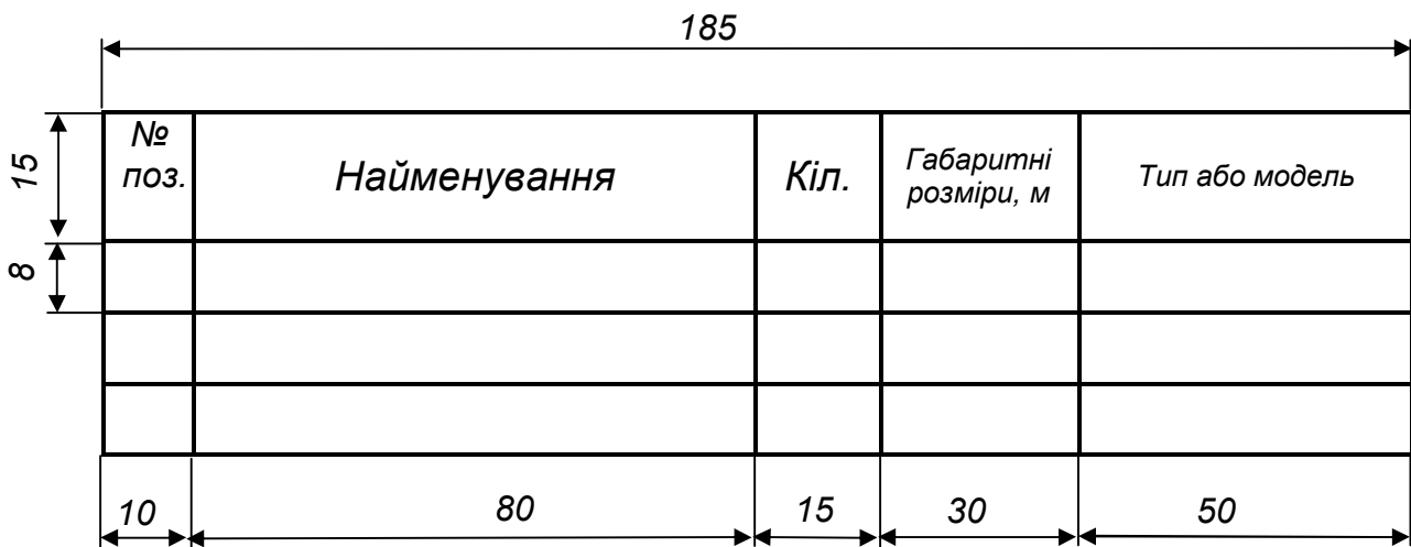
Рисунок Г.2 – Форма специфікації обладнання для технологічних планувань виробничих зон і діляниць
